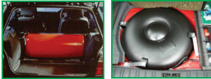
Resim 7.1. Araçlara monte edilmiş farklı şekillerdeki LPG tankları
