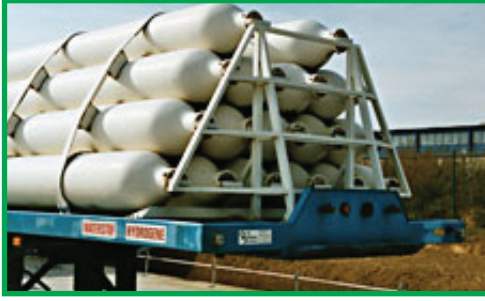
Resim 8.1 : Treylerle taşınan gaz hidrojen tüpleri
