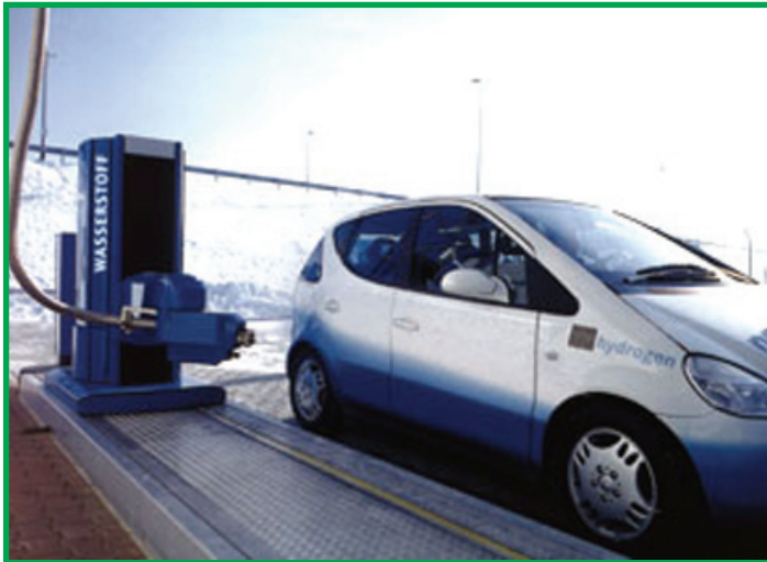
Resim 8.5. Sıvı hidrojen doldurma robotu
